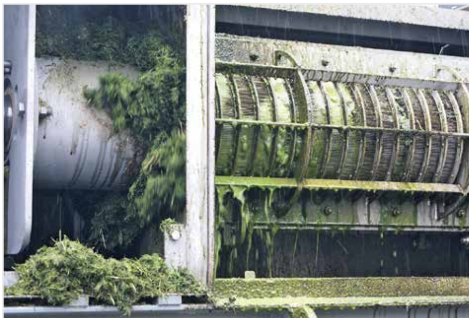
Het klavergras wordt geperst in een schroefperser. De extractie van graseiwitten beperkt de eiwitinvoer en van de bijproducten worden biogas en andere nutriënten gemaakt.
