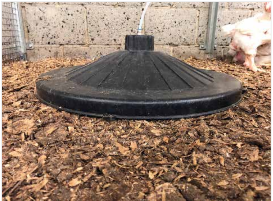
Foto 2: De NH 3 concentraties werden met deksels gemeten op strooiselniveau om de strooisellaag niet te verstoren.
