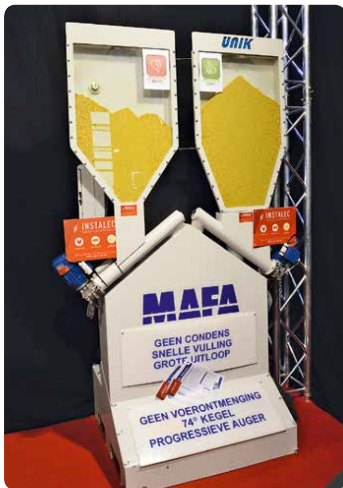
Installatiebedrijf Instalec stelde een nieuwe soort silo voor, de Mafa Unik, gemaakt van aluzinkplaat. Bemerkt de grotere opening onderaan van de Mafa Unik (rechts) t.o.v. de standaard polyester-silo (links).
