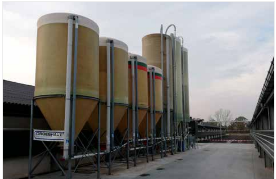
Tussen stal 2 en 3 staan 7 grote silo's en aan het einde 2 bunkerwegers vanwaar het voeder aangestuurd wordt naar de 4 stallen.
