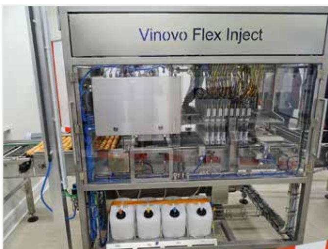
Een in-ovo injector, op maat van het bedrijf, is geïnstalleerd om de 18daagse broedeieren te vaccineren; een primeur in België.
