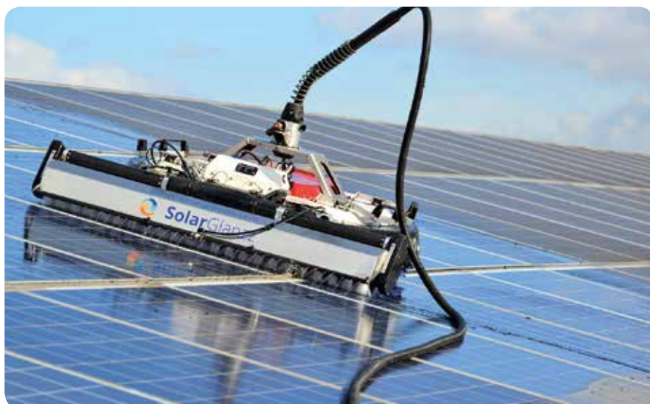
De robotreiniger van Solarglanzz kan 400 vierkante meter zonnepanelen per uur reinigen.
