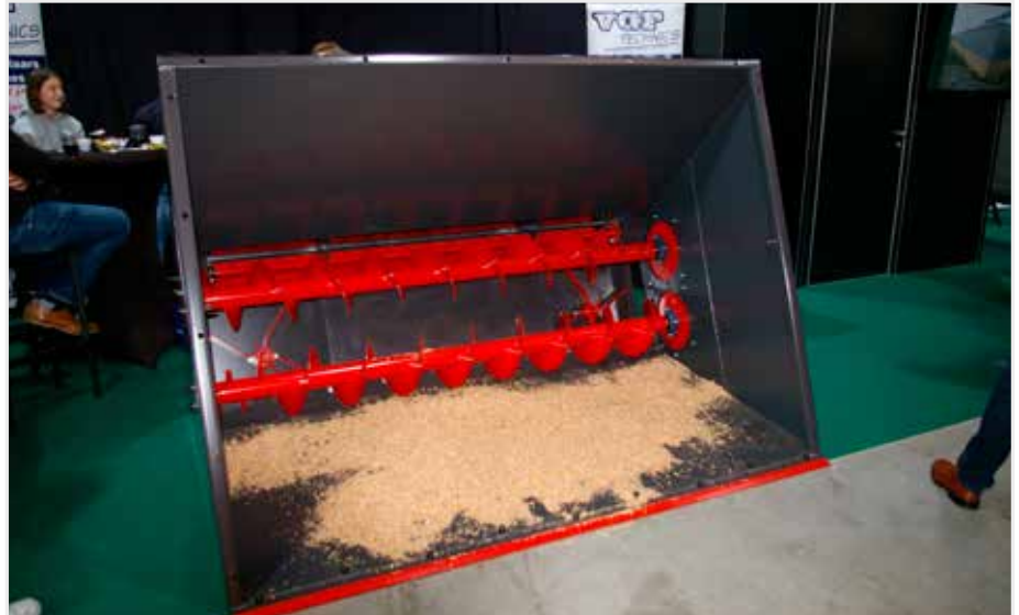
De strooiselverdeelbak van VGF Technics.
