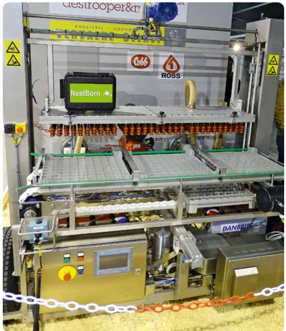
Met deze machine worden de eieren automatisch op het strooiselbed gelegd en dit in een uur tijd voor een stal met 45.000 kuikens.
